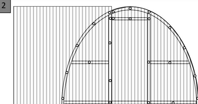
4.1.3. Второй частью поликарбоната (размером 2x2,10 м) покройте оставшуюся часть торца. Закрепите саморезами и обрежьте ровно по дуге. Оставшийся поликарбонат используйте для покрытия второго торца.
