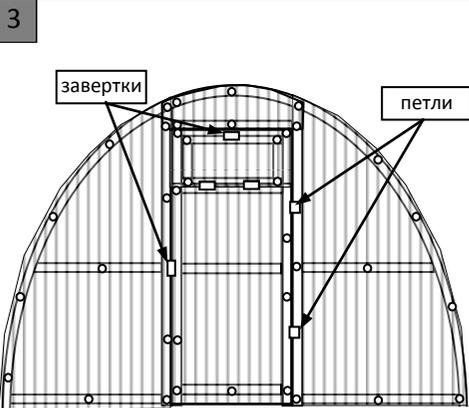
4.1.4. Установите петли на дверь и форточку с помощью саморезов. Все петли должны находиться снаружи поликарбоната. Прикрутите саморезами завертки на форточку и дверь. Затем, согласно отверстиям, прикрепите дверь.
